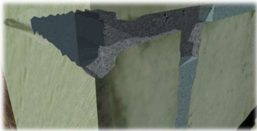
Рис. 2. Расштрабить швы, зачистить поверхность. Остановить протечки с помощью «КТтрон-8» (Водяная пробка). Зачеканить межблочные швы ремонтным составом «КТтрон-2»(Шовный).
