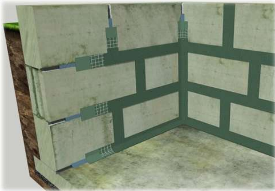
Рис. 4. После обработки швов (Смотри рис. 2) нанести обмазочную гидроизоляцию «КТтрон-10 2К» (Эластичную) с армированием стеклосеткой мелкочаеистой (5 X 5 мм). Прилегающие к швам поверхности захватить на 100 мм в каждую сторону.
