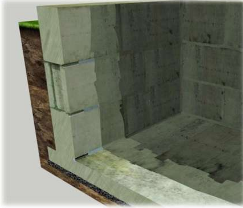
Рис. 3. Обработать все поверхности гидроизоляцией «КТтрон-1» (Проникающая) на 2 раза.
